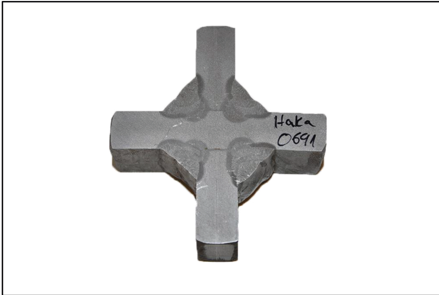
Abb. 3: Anfertigung von Makroschliffen und Härtemessung bei einem Doppel-T-Stoß nach DIN EN ISO 9018
