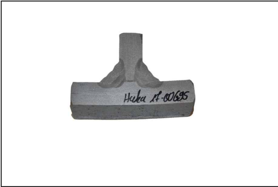
Abb. 1: Anfertigung von Makroschliffen und Härtemessung bei einer Kehlnaht
